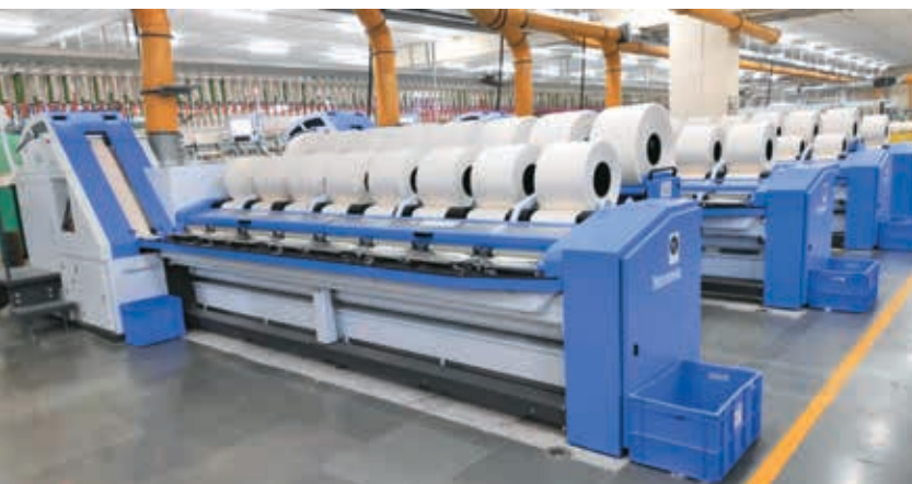
■ Máy chải kỹ TCO 12 của hãng Trützschler
