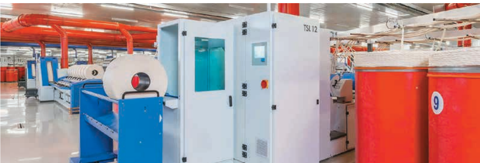
■ Máy cuộn cúi TSL 12 của hãng Trützschler
